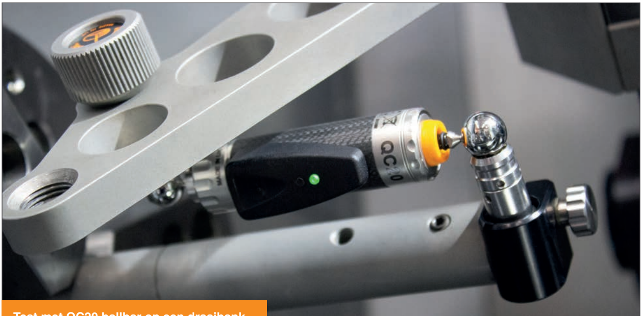
Test met QC20 ballbar op een draaibank
